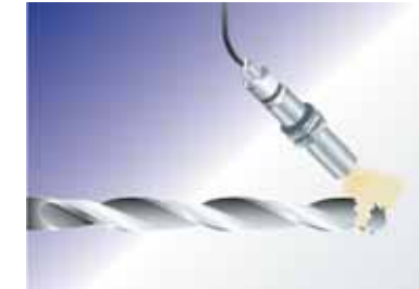
Detekcja uszkodzenia wiertła
